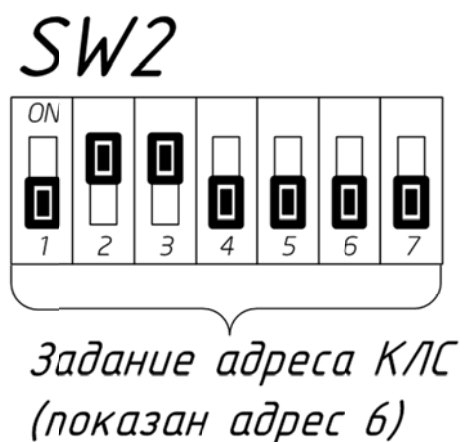
Рисунок 3. Пример установки адреса контроллера переключателями SW2
